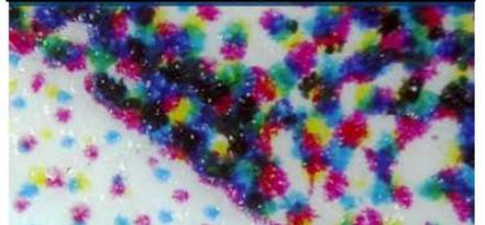
製紙の異物確認、印刷物のパッケージ、網点確認。
